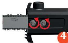
N.B. Verificare lo stato di tensione della catena. Per regolare vedi paragrafo "Regolazione tensione maglia catena"
